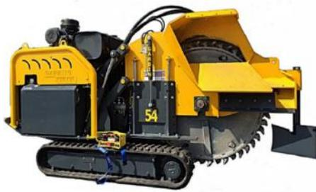
**TRANCHEUSE A FIBRE OPTIQUE FIBER 450E**
