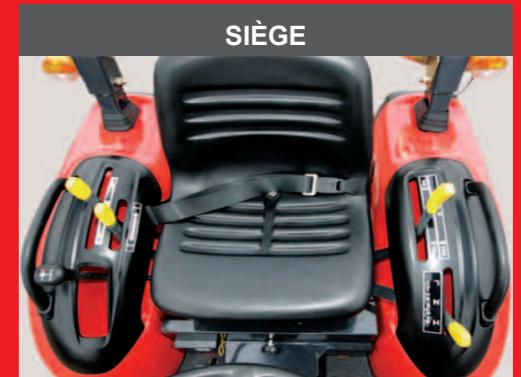
Les leviers de commande sont placés à portée de main, à gauche et à droite du siège, pour une commande ergonomique.
