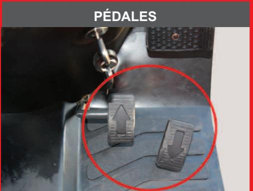
Pédales de commande hydrostatiques pour rouler souplement, sans mains, en avant et en arrière (modèle hst).
