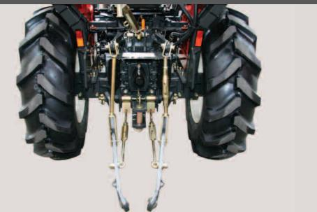
La structure de levage à 3 points Catégorie I a une capacité de levage de 650 kg.
