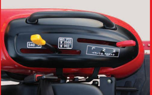
Prise de force levier facile à manipuler, pour 2 vitesses arrière et 1 vitesse centrale.
