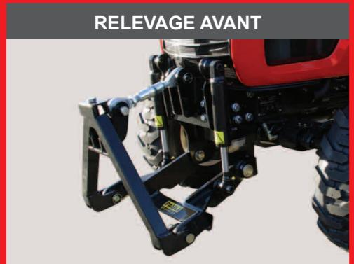
Relevage avant cat. 0 avec une force de levage de 700 kg.
